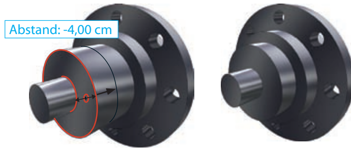
Modellieren, wie man es sich vorstellt: Einen Flansch direkt mit Drücken und Ziehen umformen.
