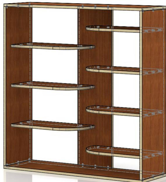
Beim Platzieren erkennt das Werkzeug „Bohrung 3D“ automatisch die Oberflächen von Bauteilen.
